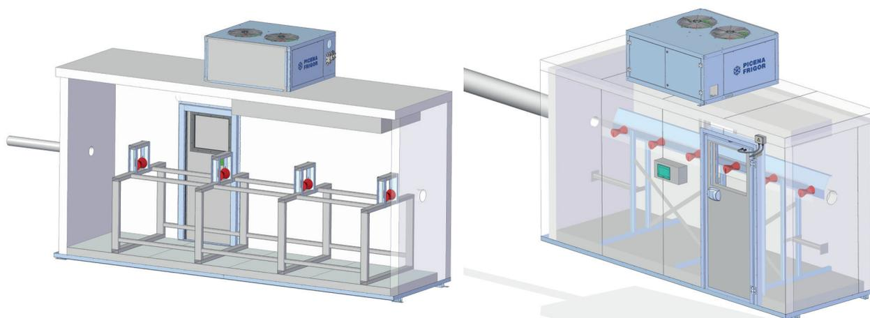
Frigoriferi da inserire lungo la linea di produzione dei tubi in gomma rinforzati, mediante spiraleratura su mandrino rigido. Sono progettati con diverse lunghezze per essere inseriti lungo la linea di produzione in modo che il sottostrato giunga alla spiraleratrice con la corretta temperatura.
